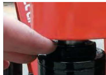
Hubzylinder fährt nicht komplett ein – Schutz vor Quetschungen
