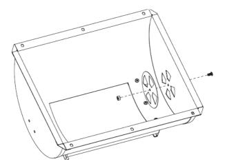
Befestigen Sie den Brennkammer-Deckelstopper mit Hilfe von einer M6x12 Schraube und einer Mutter:
