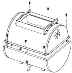
• Schrauben Sie zwei M6x12 Schrauben ca. zur Hälfte in die entsprechenden seitlichen Bohrlöcher der Brennkammer:
