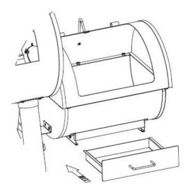
• Führen Sie den Kannenhalter durch das Bohrloch in der Grillkammer ein, so dass dieser danach unter der Grillkammer hängt.
