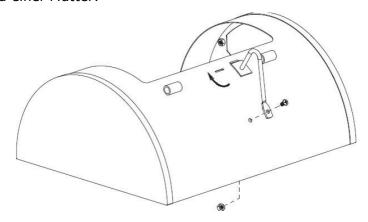
• Verbinden Sie das untere bzw. obere Brennkammerteil mit Hilfe von sechs M6x12 Schrauben.
