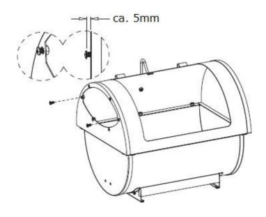
Richten Sie die Brennkammer an der Seite der Grillkammer aus, (richten Sie die Schlitze der Grillkammer an den beiden zuvor zur Hälfte eingeschraubten Schrauben der Brennkammer aus) und schieben Sie sie hinein.
