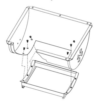
• Befestigen Sie den Brennkammer-Lüfter mit Hilfe von M6x12 Schrauben und der silbernen Sicherungsmutter:
