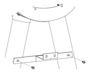
• Montieren Sie die Aschebehälter-Halterung mit Hilfe von M6x12 Schrauben.
