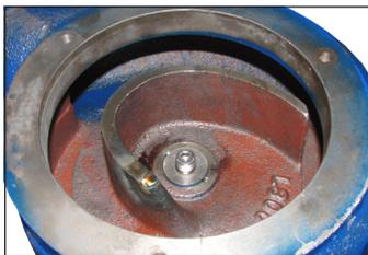
Pumpenrad mit Hartmetall Schneidekante dadurch leichtes Fördern von Blättern, Algen, Stroh, Gülle usw. möglich.
