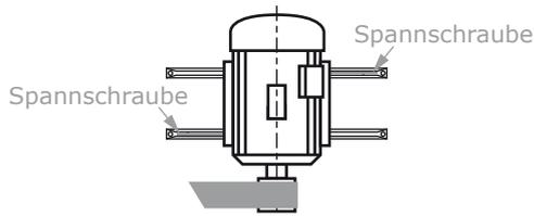
Die Einstellung der Riemenspannung muss mit größter Sorgfalt erfolgen. Sollte die Spannung zu hoch sein verschleifen die Wellenlager sehr schnell und es kann sogar zum Bruch des Lagerschildes oder der Welle kommen. Ist die Spannung zu gering kommt es zu Schwingungen, welche ebenfalls das Gerät beschädigen kann.
