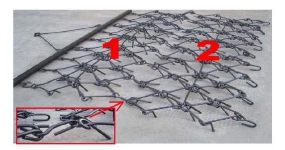
• Verbinden Sie das dritte Segment (3) mit dem ersten Segment (2). Führen Sie hierzu die Haken des dritten Segments (3) in die entsprechenden Ösen des zweiten Segments (2) ein (siehe Abbildung unten).
