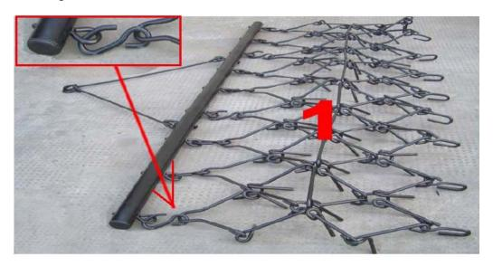
• Verbinden Sie das zweite Segment (2) mit dem ersten Segment (1). Führen Sie hierzu die Haken des zweiten Segments (2) in die entsprechenden Ösen des ersten Segments (1) ein (siehe Abbildung unten).
