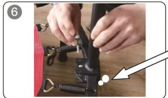
7. Montieren Sie die seitlichen Stützstangen, fixieren Sie diese mit den Schrauben.
