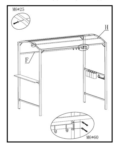
• Befestigen Sie nun die Dachplane mit den Schlaufen und fixieren Sie den Grillpavillon mit dem Untergrund.
