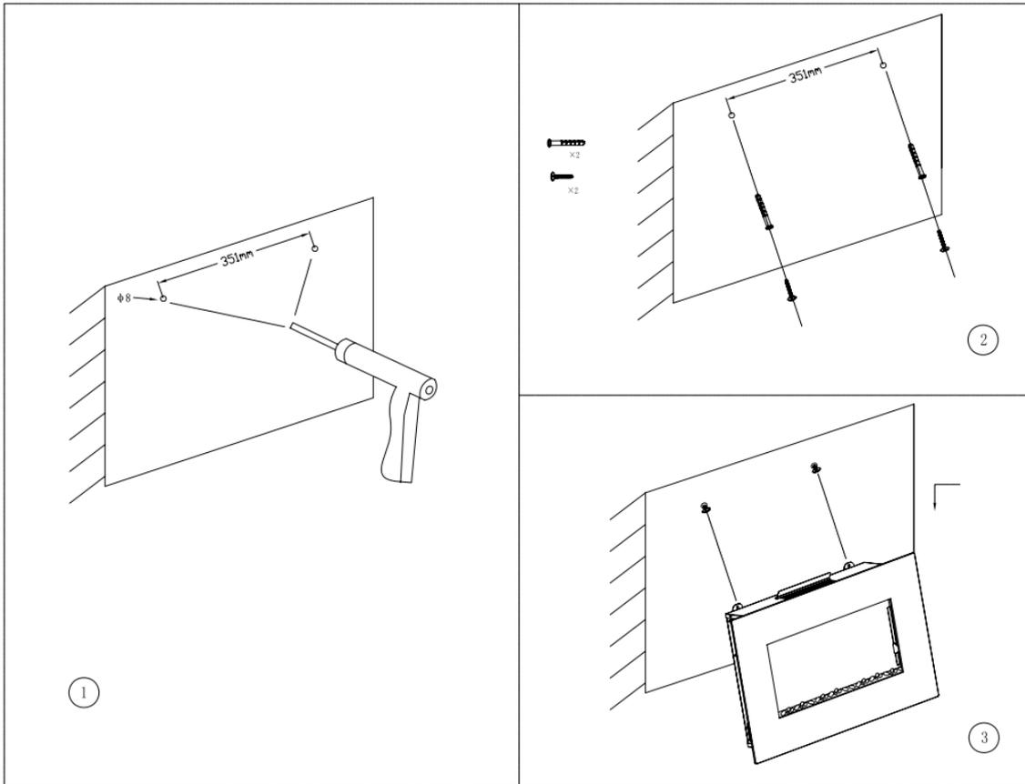
2. Setzen Sie nun die Dübel in die Bohrlöcher, sodass diese fest und sicher sitzen. Schrauben Sie anschließend die Schrauben in die Dübel. Hängen Sie nun das Gerät auf den Schrauben ein, wie in obiger Skizze, Teil 3, zu sehen. An der Oberkante der Rückseite des Geräts befinden sich zu diesem Zweck zwei leicht abstehende Bügel/Ösen, siehe folgende Skizze:
