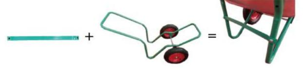
Zuletzt die Wanne mit Hilfe der Schrauben M8X45(7), M8 Unterlegscheiben (8) und MutternM8 (9) befestigen.
