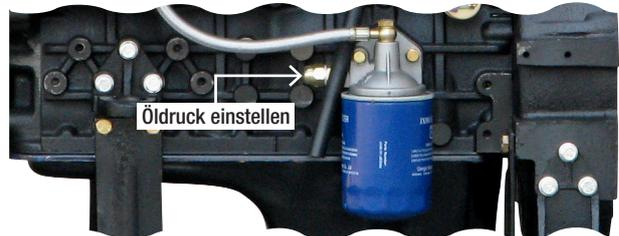
Der Öldruck wird über den Ölfilterflansch justiert (Hutmutter entfernen, Kontermutter öffnen und Öldruck einstellen).
