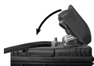
Bild 4: Batterie Schnellverbinder verriegeln
