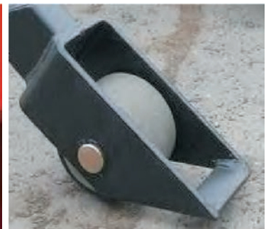
Verbesserte Radaufnahme der Gabelrollen für mehr Standsicherheit
