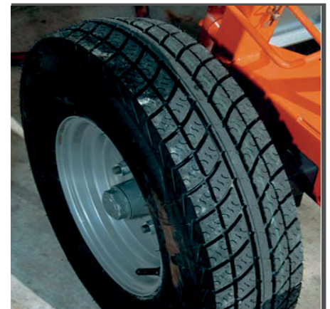
Fahrwerk mit 13 Zoll Stahlfelgen und 135er Luftbereifung.
