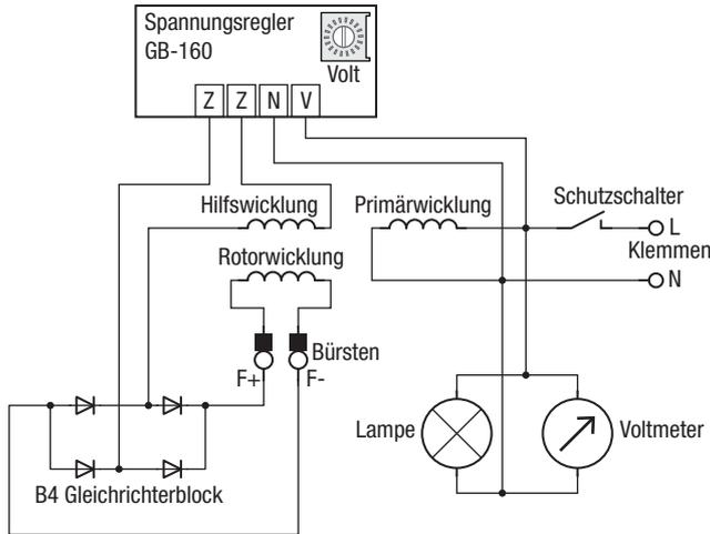
Über den Regler „VOLT“ kann die Ausgangsspannung des Generators eingestellt werden.
