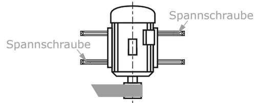
Die Einstellung der Riemenspannung muss mit größter Sorgfalt erfolgen. Sollte die Spannung zu hoch sein verschleiben die Wellenlager sehr schnell und es kann sogar zum Bruch des Lagerschildes oder der Welle kommen. Ist die Spannung zu gering kommt es zu Schwingungen, welche ebenfalls das Gerät beschädigen kann.
