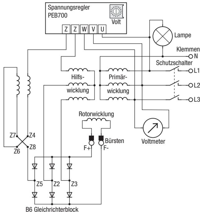
Über den Regler „VOLT“ kann die Ausgangsspannung des Generators eingestellt werden.
