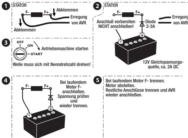
Die Ausgangsspannung sollte in Sternschaltung zwischen 2 beliebigen Phasen in etwa 100 - 200V betragen.
